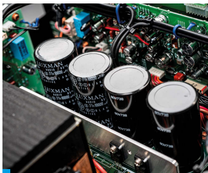
Główne kondensatory filtrujące w zasilaczu są takie same, jak w droższym modelu.
