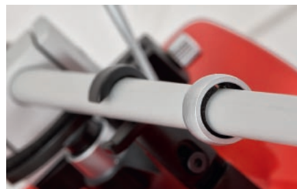
Tajemniczy pierścień, umieszczony mniej więcej w połowie długości ramienia, to część systemu tłumiącego drgania.
