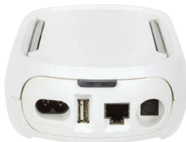
Do Dialoga podłączymy także zewnętrzne cyfrowe źródło w standardzie optycznym; port USB rodzi nadzieje na jeszcze większe możliwości, ale na razie nie jest aktywny.
